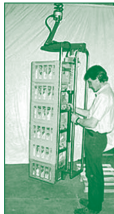
Manipulador ingrávito para levantar y mover pilas de cajas.
